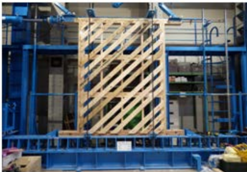
写真-2 床02型試験体壁倍率実験
