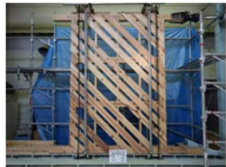
写真-1 床01型試験体壁倍率実験
