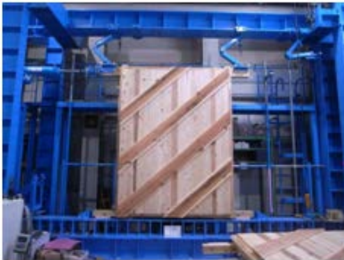
写真-4 屋根02型試験体壁倍率実験
