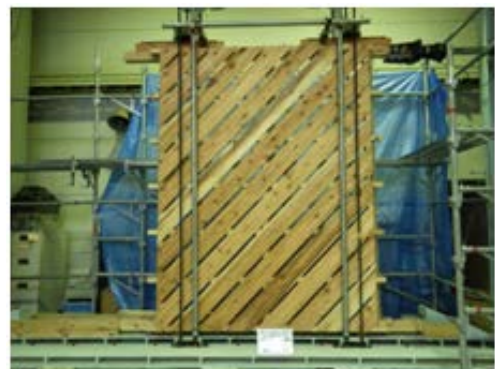
写真-3 屋根01型試験体壁倍率実験
